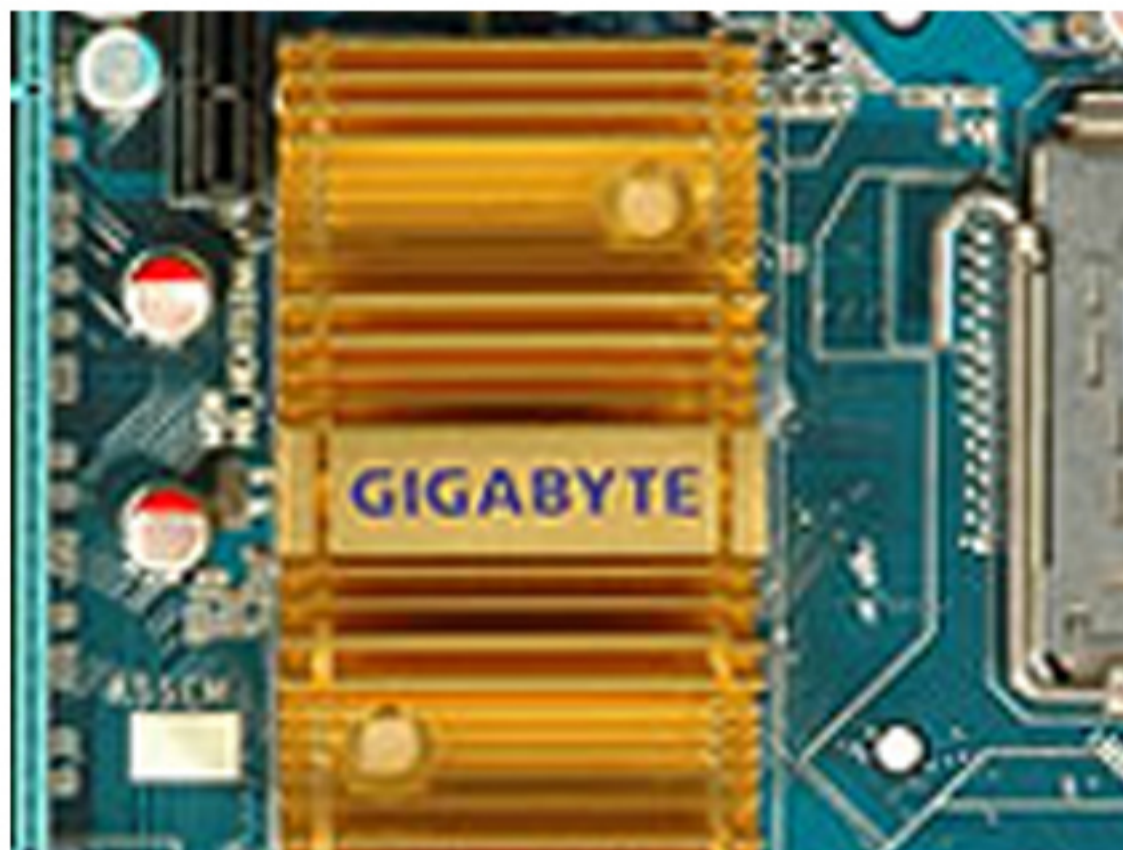
Hər bir Ana kart üzərində olması vacib sayılan cihaz(Chipset) Şəkil 2
