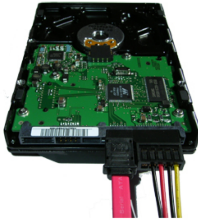
HDD (Sabit-Sərt Disk) Kabel qoşulması Qeyd: Sol tərəfdəki kabel Ana karta, sağ tərəfdəki isə enerji paylayıcısına qoşulur. Şəkil 8.
